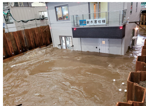
図5 洪水時の家屋の揺れを実験で再現
