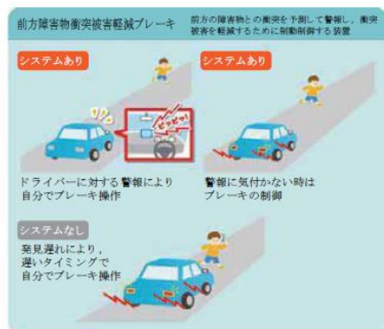
図7 衝突被害軽減ブレーキの概要 8)
